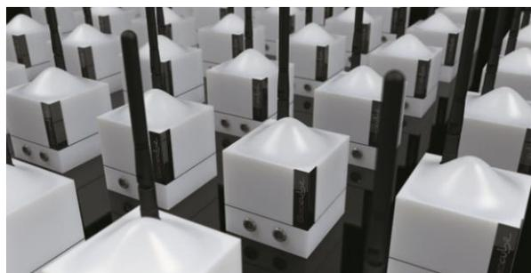
Le laboratoire d'optoélectronique, de métrologie et d'instrumentation (LOEMI) de l'IGN a développé un appareil autonome ultra-compact et ultra-précis, le Géocube. Fonctionnant en réseau, il assure la surveillance des zones à risque et des ouvrages d'art.
