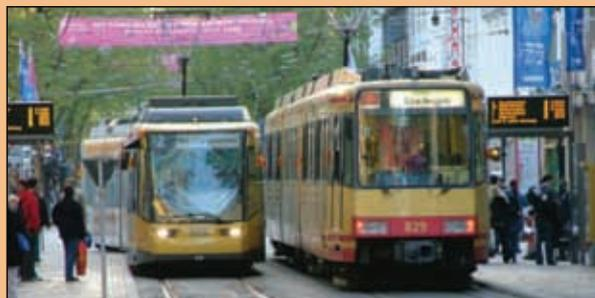
Photos ci-dessus : les mêmes véhicules peuvent emprunter le réseau de chemin de fer et le réseau urbain de tramway
