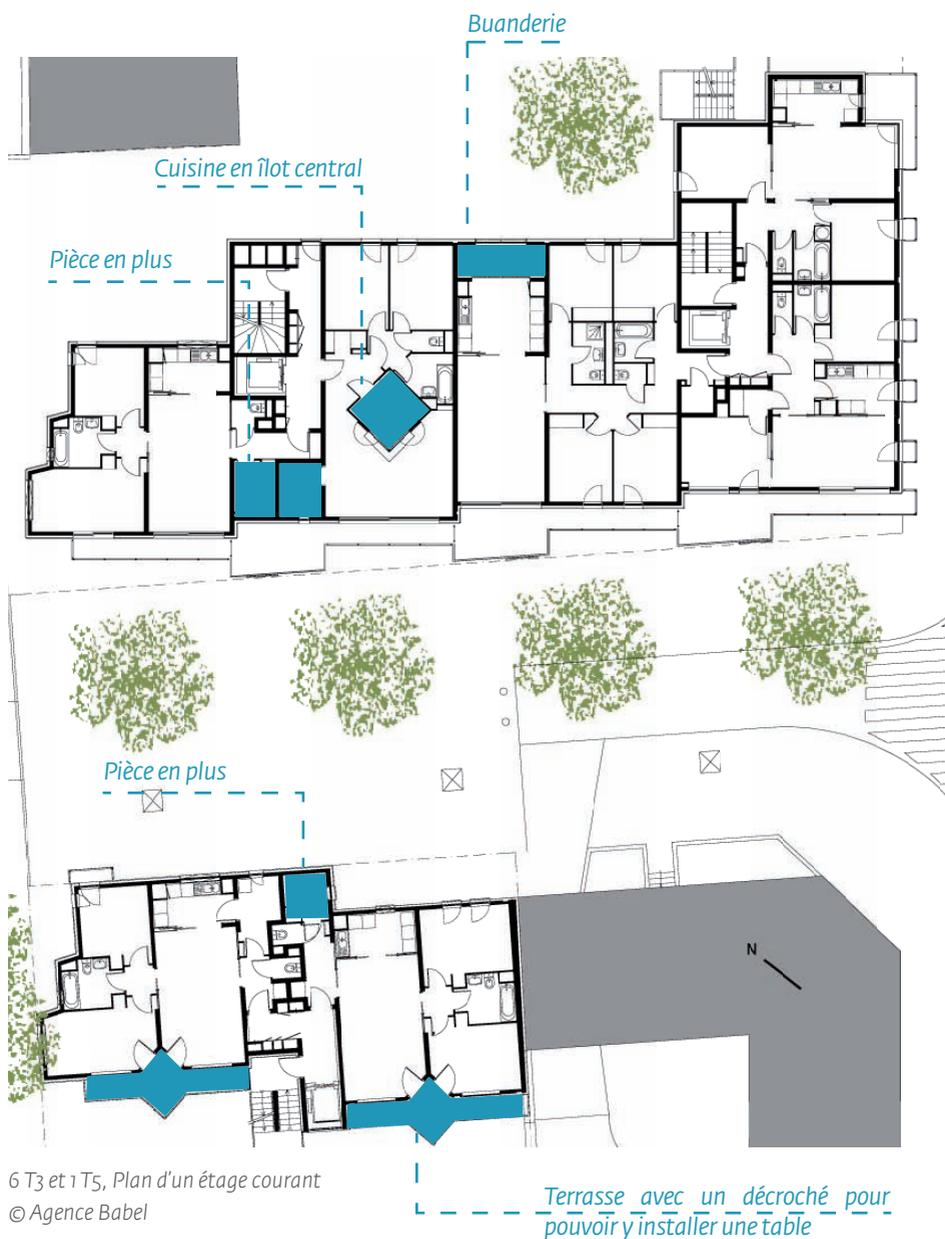
6 T3 et 1 T5, Plan d'un étage courant
